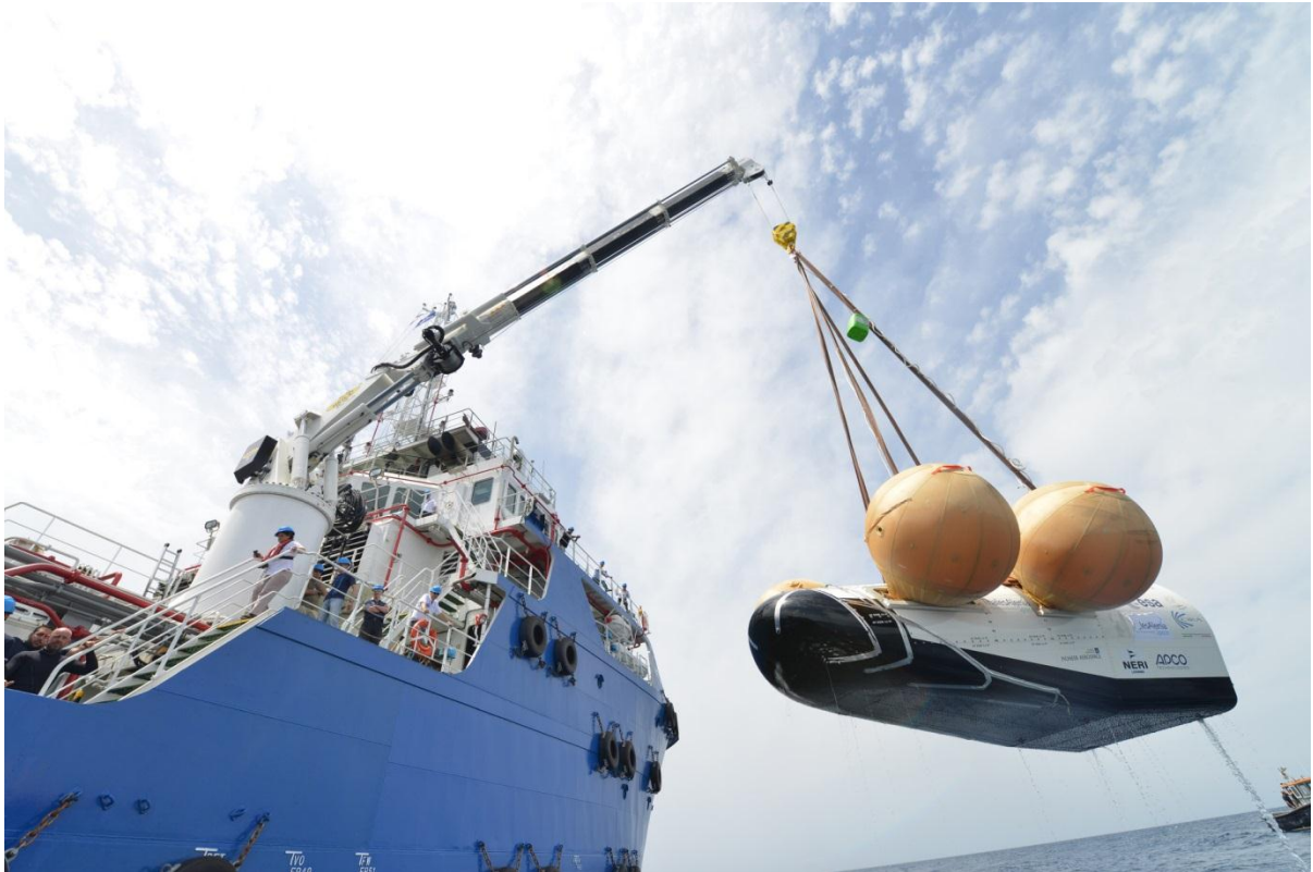
Der Prototyp von IXV wird während eines vorbereitenden Tests im Juni 2014 vom Bergungsschiff an Bord geholt. Bei den orangen Ballons handelt es sich um Schwimmkörper, welche nach dem Aufsetzen aufgeblasen werden und sicherstellen, dass IXV in korrekter Lage auf dem Wasser aufschwimmt (Bild: ESA)
