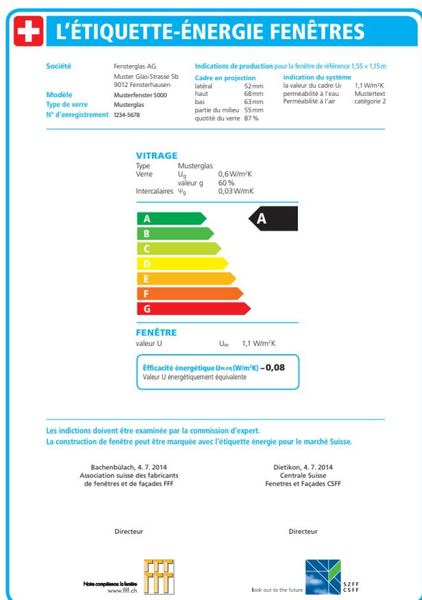
**Qualité du cadre  $U_f$**  : le coefficient de transmission thermique moyen des cadres de fenêtres dépend du matériel utilisé pour le cadre et du profil de celui-ci. Plus la valeur est petite, plus la déperdition de chaleur est faible.
