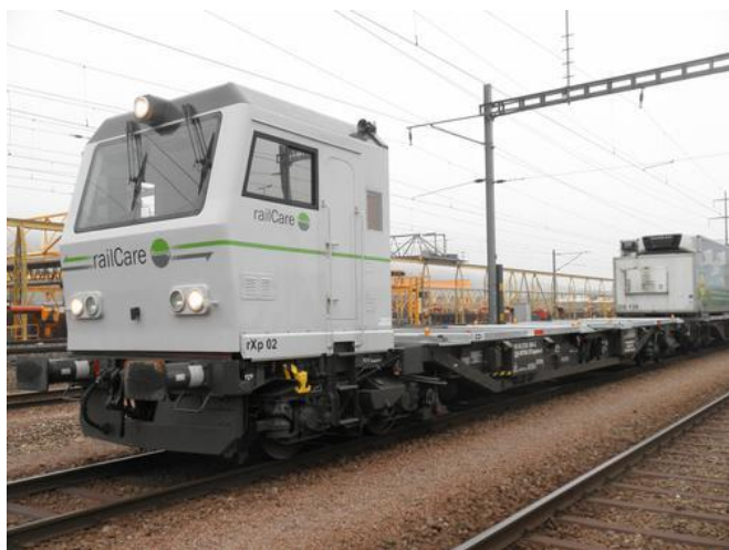
Abbildung 5: Pendelzugeinheit der railCare AG (Quelle: railCare AG) und aufsteckbare Führerkabine (Quelle: ASK Cargojet)
