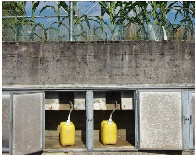
**Das Sickerwasser wird im mit Mais bepflanzten Ly-simeter mit Kanistern aufgefangen und anschlies-send analysiert.**
