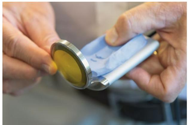
Elastische Membran mit Olivenöl als Kupplungsflüssigkeit: Druckmesser von Veinpress für die Messung des zentralen Venendrucks.
