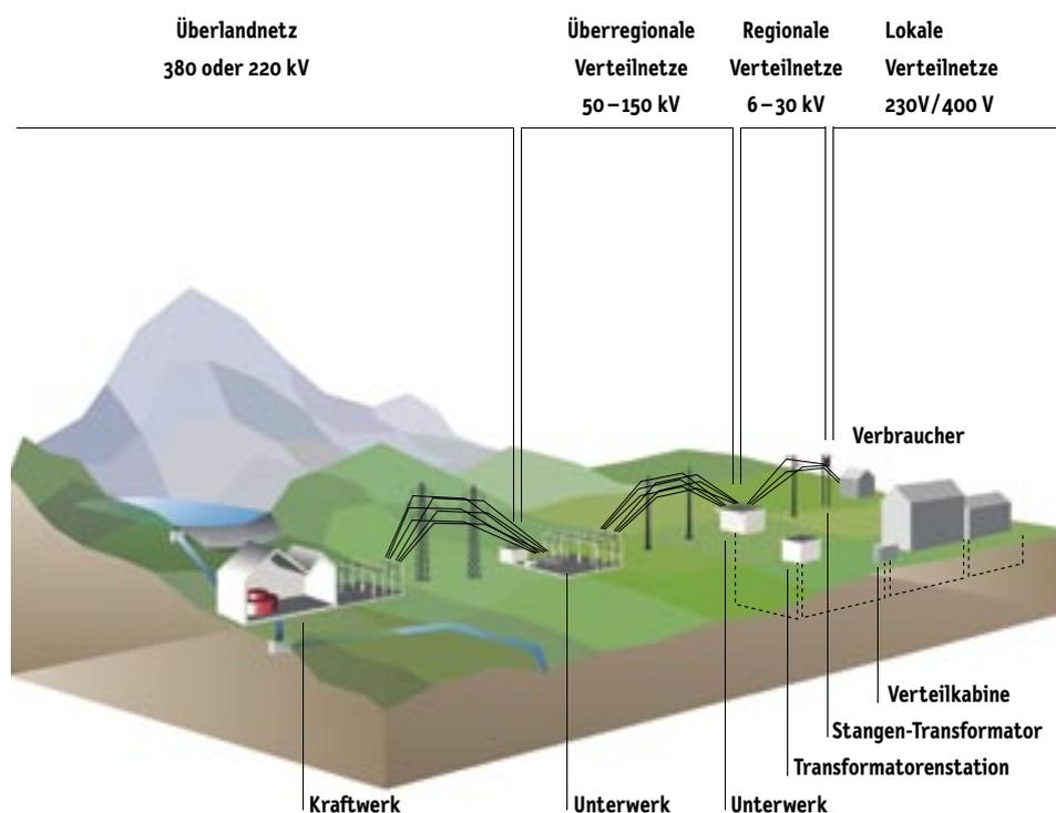
Vom Kraftwerk bis zum Endverbraucher muss der Strom zuerst auf höhere und später wieder auf tiefere Spannungen umgewandelt werden. Sowohl entlang der Leitungen als auch in der näheren Umgebung der Transformatorenstationen gibt es elektrische und magnetische Felder.
