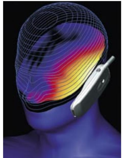
Berechnetes Beispiel der Strahlungsbelastung des Kopfes beim Telefonieren mit einem Handy: Das dargestellte Mobiltelefon hat einen SAR-Wert von 0,61 W/kg. Die höchste Belastung tritt im weiss-gelben Bereich in den äussersten Schichten des Kopfes auf. Gegen innen nimmt die Intensität stark ab. Im schwarzen Bereich ist sie 100 000-mal kleiner als aussen.
