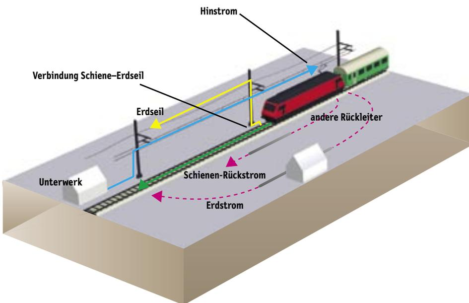
Vom Unterwerk aus werden die Lokomotiven über den Fahrdraht mit Strom versorgt (blauer Pfeil). Über die Schienen (grüner Pfeil), das Erdseil (gelber Pfeil), das leitende Erdreich und andere Rückleiter im Boden (rote Pfeile) fliesst der Strom dann zurück ins Unterwerk. Bedingt durch die Distanz zwischen den Hin- und Rückströmen ist die räumliche Ausdehnung des resultierenden Magnetfeldes von Eisenbahn-Fahrleitungen relativ gross.
