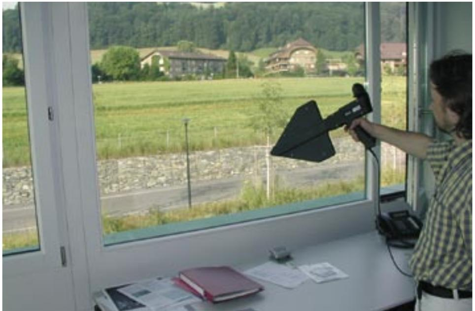
Mit dieser handgeführten Messantenne (oben) wird die höchste Belastung im Raum ausfindig gemacht. Der Spektrumanalysator (Mitte und unten) bildet die Resultate der frequenzselektiven Messung ab. Da jede Frequenz separat erfasst wird, lässt sich die Strahlung einer einzelnen Mobilfunkanlage gezielt ermitteln.
