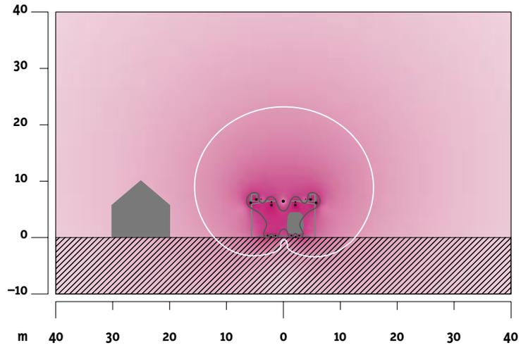
Magnetfeld bei einer typischen Doppelspurstrecke. Auf der dargestellten Hüllfläche in der perspektivischen Ansicht (links) beträgt die über 24 Stunden gemittelte magnetische Flussdichte 1 Mikrottesla ( $\mu\text{T}$ ). Der Schnitt durch das Magnetfeld senkrecht zum Bahntrassee (rechts) zeigt, wie die Belastung mit zunehmendem Abstand von der Fahrleitung abnimmt. Die graue Linie entspricht einem 24-Stunden-Mittelwert von  $10 \mu\text{T}$  und die weisse Linie einem Wert von  $1 \mu\text{T}$ .
