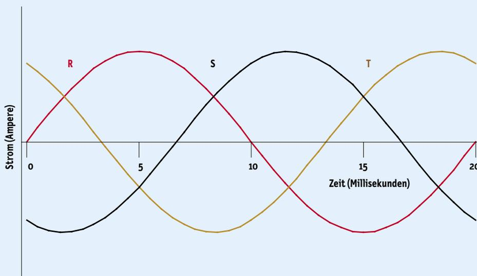
Beim Dreiphasenwechselstrom sind die Ströme in den drei Leitern zeitlich jeweils um den Drittel einer Schwingungsperiode verschoben. Die verschiedenen Phasen werden mit R, S und T bezeichnet.
