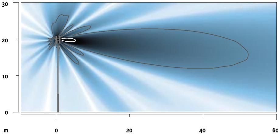
Strahlung in der Umgebung einer Mobilfunkantenne mit einer äquivalenten Sendeleistung von 1000 Watt ERP im Frequenzbereich um 900 MHz (GSM900). Die Antenne befindet sich auf einem 20 Meter hohen Mast und ist leicht gegen den Boden gerichtet. Die Bedeutung der ausgezogenen Linien ist in der Farbskala unten dargestellt.
