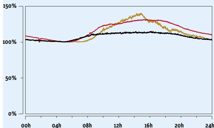
**Tagesverlauf der Strahlungsimmissionen von drei verschiedenen Basisstationen. Dargestellt ist die elektrische Feldstärke während 24 Stunden in % des Grundpegels. Bei 100% senden nur die Steuerkanäle.**
