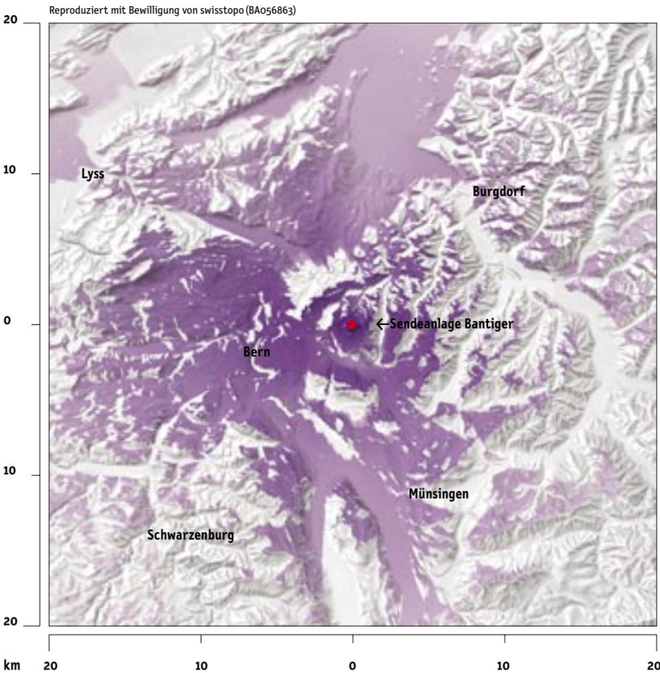
**Darstellung der elektrischen Feldstärke im Umkreis der Sendeanlage Bantiger BE. Es handelt sich um eine Berechnung unter vereinfachten Annahmen, welche die Beugung und Reflexion der Strahlung nicht berücksichtigt. Auf Grund der Topografie besteht im Bereich der weissen Flächen kein Sichtkontakt zum Sender. Obwohl die elektrische Feldstärke hier mit weniger als 0,1 V/m gering ist, sind Radio- und Fernsehempfang meistens noch möglich.**
