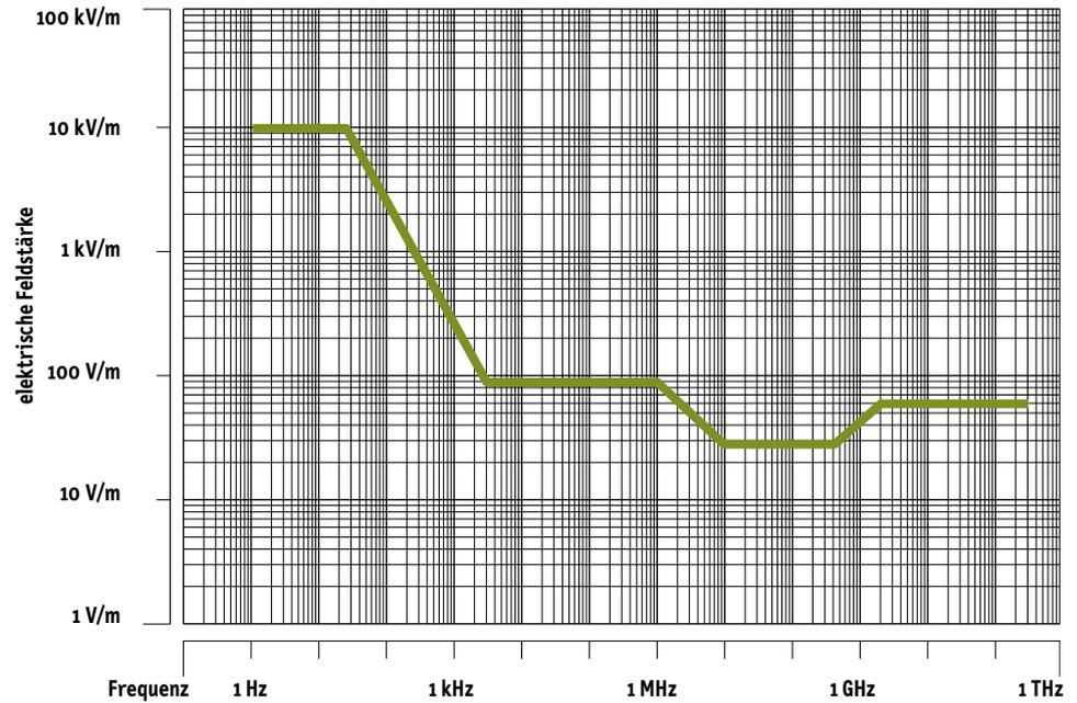
Die in der NISV vorgeschriebenen Immissionsgrenzwerte (grüne Linie) für die elektrische Feldstärke variieren je nach Frequenz der Strahlung. Denn die Wirkungen auf den Menschen treten in Abhängigkeit von der Frequenz bei verschiedenen Intensitäten auf.
