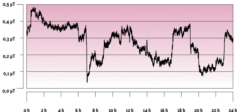
Beispiel für den zeitlichen Verlauf des Magnetfeldes in der Nähe einer 220-kV-Hochspannungsleitung während 24 Stunden an einem Werktag im Januar. Das Magnetfeld schwankt je nachdem, wie grosse Ströme die beiden Leitungsstränge führen.
