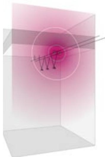
**Niedervolt-Halogenbeleuchtungssysteme erzeugen die stärksten Magnetfelder aller elektrischen Beleuchtungen. Sind sie an der Decke montiert, können sie auch in den darüber liegenden Räumen zu recht hohen Belastungen führen.**
