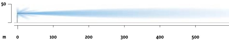
Schematische Darstellung der Strahlung einer Richtfunkanlage. Die Bedeutung der Farben ist in der unten stehenden Skala ablesbar.
