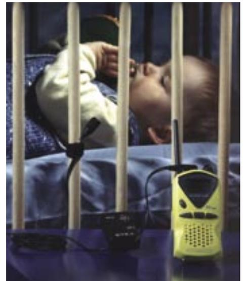
Babyfone dienen der akustischen Überwachung von Säuglingen und Kleinkindern. Dabei nimmt das Sendegerät über ein Mikrofon die Laute des Babys auf und übermittelt sie an einen Empfänger, der die Geräusche über einen Lautsprecher wiedergibt. Die beiden Apparate können entweder über ein eigenes Kabel, das Hausstromnetz oder über Funk miteinander verbunden sein.
