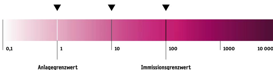
Skala der magnetischen Flussdichte in Mikrottesla ( $\mu\text{T}$ ).
