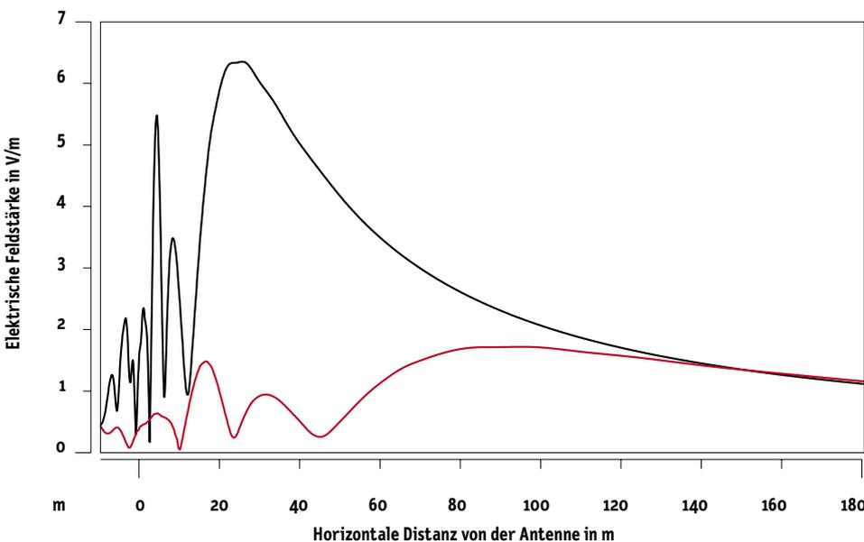
**Strahlung in der Umgebung einer Mobilfunkanlage**
