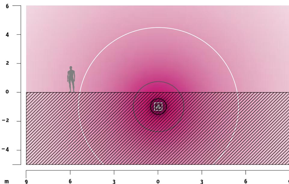
**Schnitt durch das Magnetfeld einer erdverlegten Kabelleitung. Hier befindet sich der Rohrblock 0,8 Meter unter der Erdoberfläche. Weil die je 745 A Strom führenden Leiter nahe beieinander liegen, ist die räumliche Ausdehnung des Magnetfeldes deutlich kleiner als bei Freileitungen, und die Belastung nimmt mit zunehmendem Abstand auch schneller ab.**
