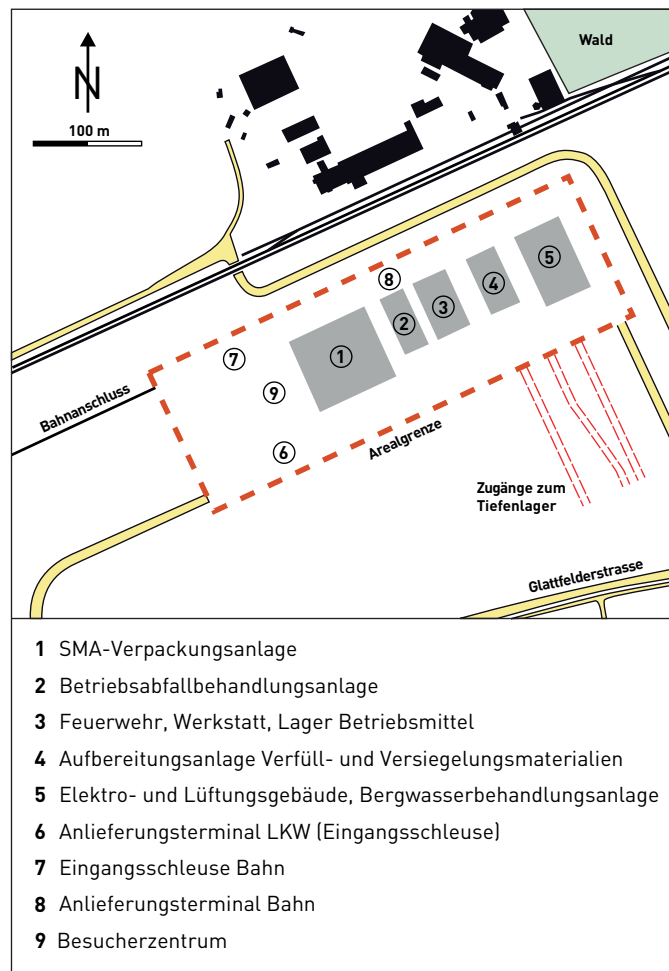
Bild 3b: Mögliche Anordnung der Anlagenteile der Oberflächenanlage für Tiefenlager SMA
