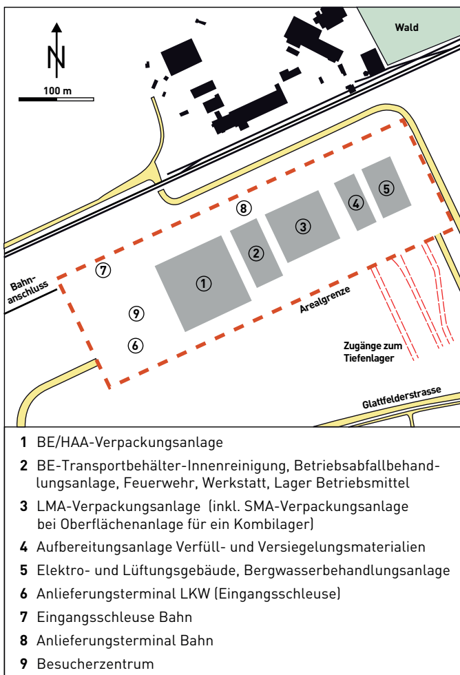
Bild 3a: Mögliche Anordnung der Anlagenteile der Oberflächenanlage für Tiefenlager HAA/Kombi
