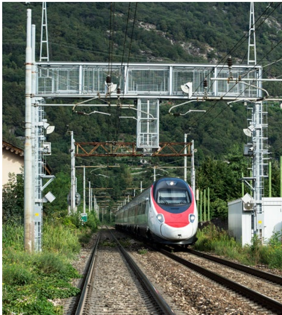
Une nouvelle installation de détection de profil et d'antennes à Domodossola identifie les trains à risque.
