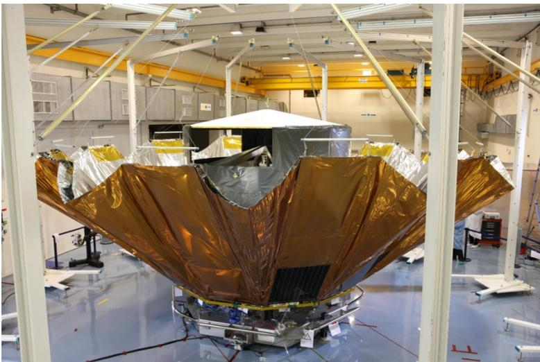
Test des faltbaren Sonnenschutzes von Gaia (Bild: ESA).
