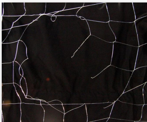
Abb. 10: Vier gerissene Maschen in einem Versuchsnetz. Die Zuordnung zu Grössenklassen erfolgte analog. Solche Löcher können unter anderem von Kormoranen verursacht werden (Foto © 2010 Klaus Robin).
