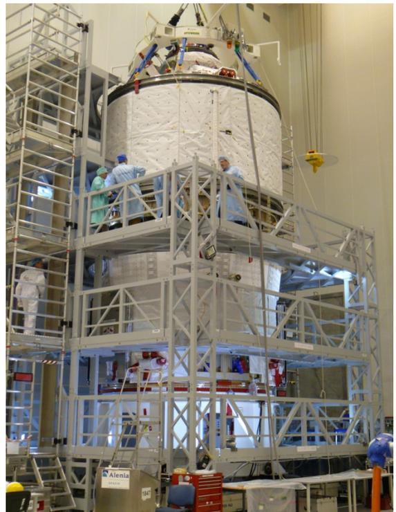
L'ICC chargé (en-haut) est hissé à l'aide d'une grue, positionné au-dessus du module de service et assemblé à ce dernier. Le module de service contient les propulseurs de manœuvre de l'ATV et il alimente le vaisseau en électricité (image: ESA).
