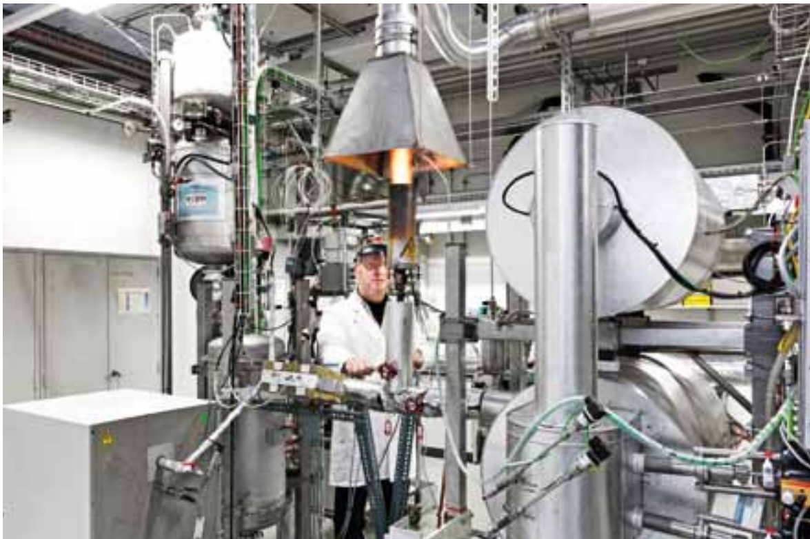
In dieser Laboranlage stellen Forschende des PSI aus dem Naturrohstoff Holz energiereiches Gas her. Das Verfahren wandelt das Holz in synthetisches Erdgas um, das in öffentliche Gasleitungen eingespeist werden kann. Dadurch wird die Energie aus Holz für die Stromerzeugung in Gaskraftwerken oder den Autoantrieb verfügbar. Zugleich wird damit eine sehr umweltfreundliche Energiequelle erschlossen, da die Holzvergasung CO 2 -neutral ist. (Scanderbeg Sauer Photography)
