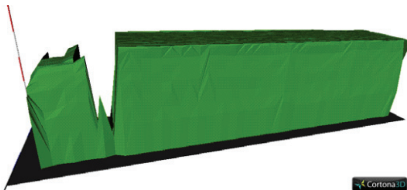
Abbildung 44: Laserscan eines Sattelschleppers
