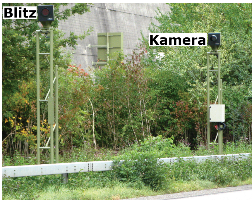
Abbildung 46: Fahrererkennungssystem mit Beweisbildkamera und Blitzlicht beim Pilotabschnitt A2 Arisdorftunnel
