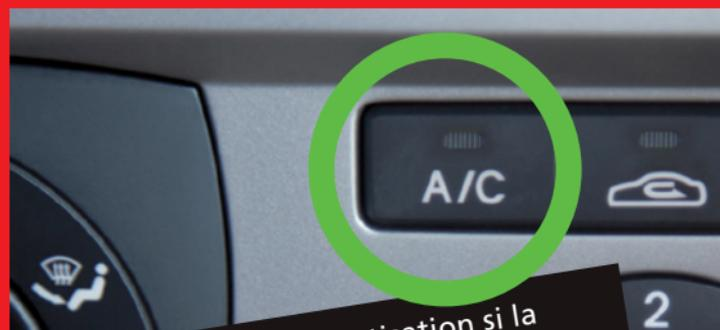
Coupez la climatisation si la température extérieure est inférieure à 18°C (sauf si le pare-brise est embué).
