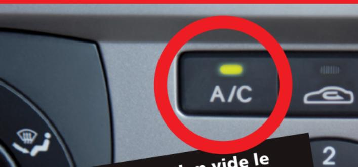
La climatisation vide le réservoir parce qu'elle refroidit d'abord l'air jusqu'à 3°C, puis le réchauffe à nouveau.
