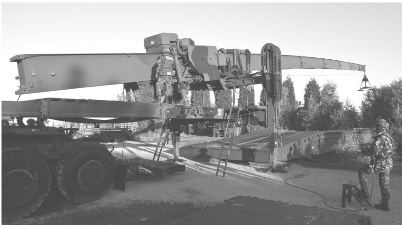
Unità di posa in posizione di lavoro
