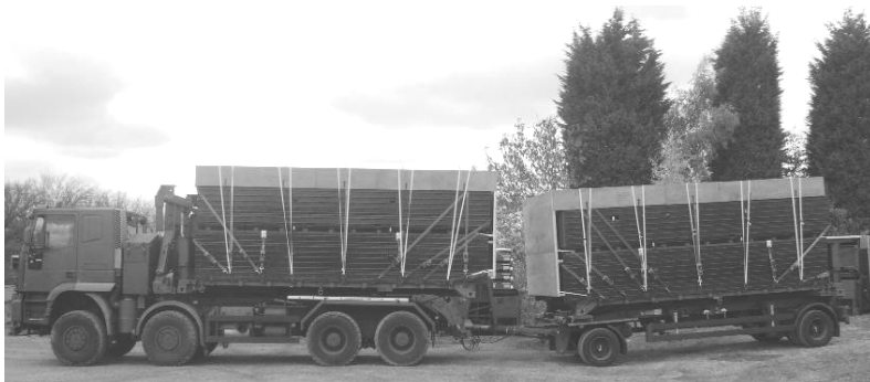
Materiale per ponti caricato su unità di trasporto e autocarro/rimorchio
