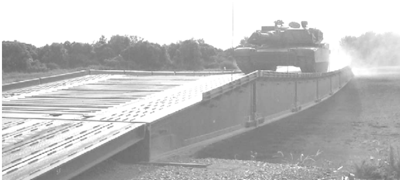
Transito di un carro armato su un ponte di supporto 45 m operativo
