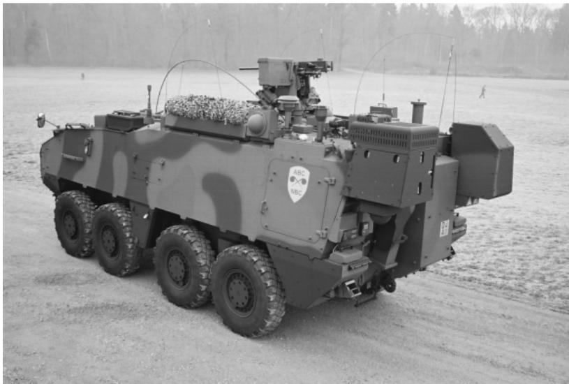
Véhicule d'exploration NBC réalisé sur la base d'un châssis PIRANHA III C
