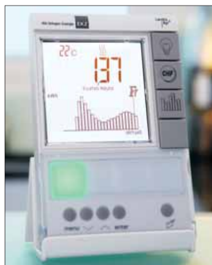
L'Ecometer placé dans la maison indique la consommation de courant en temps réel.
