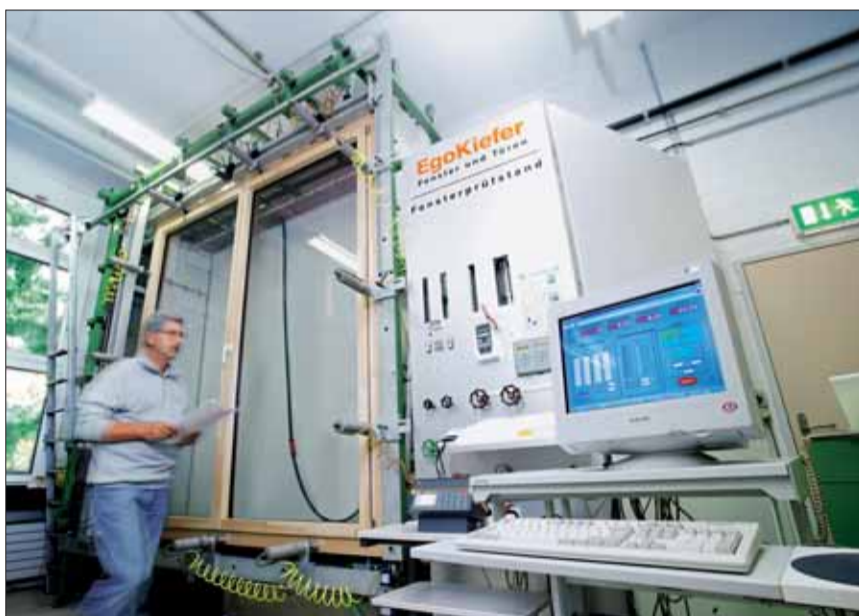
Neue Fensterkonstruktionen werden im Testlabor unter extremsten Bedingungen auf Herz und Nieren geprüft. (Fotos: EgoKiefer AG)
