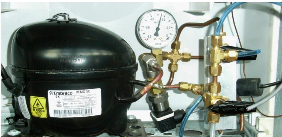
Abb. 7: Drehzahlgeregelter Kompressor Embraco VCC3 VEM X5C mit Befüllsystem, eingebaut im modifizierten Kühlschrank
