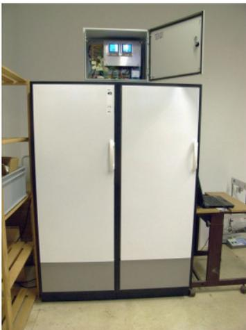
*Abb. 16 Referenzkühlschrank (links) und modifizierter Kühlschrank (rechts) in das gleiche Möbel eingebaut, um identische äussere Bedingungen zu ermöglichen. Im Gehäuse oben befindet sich die Messelektronik*
