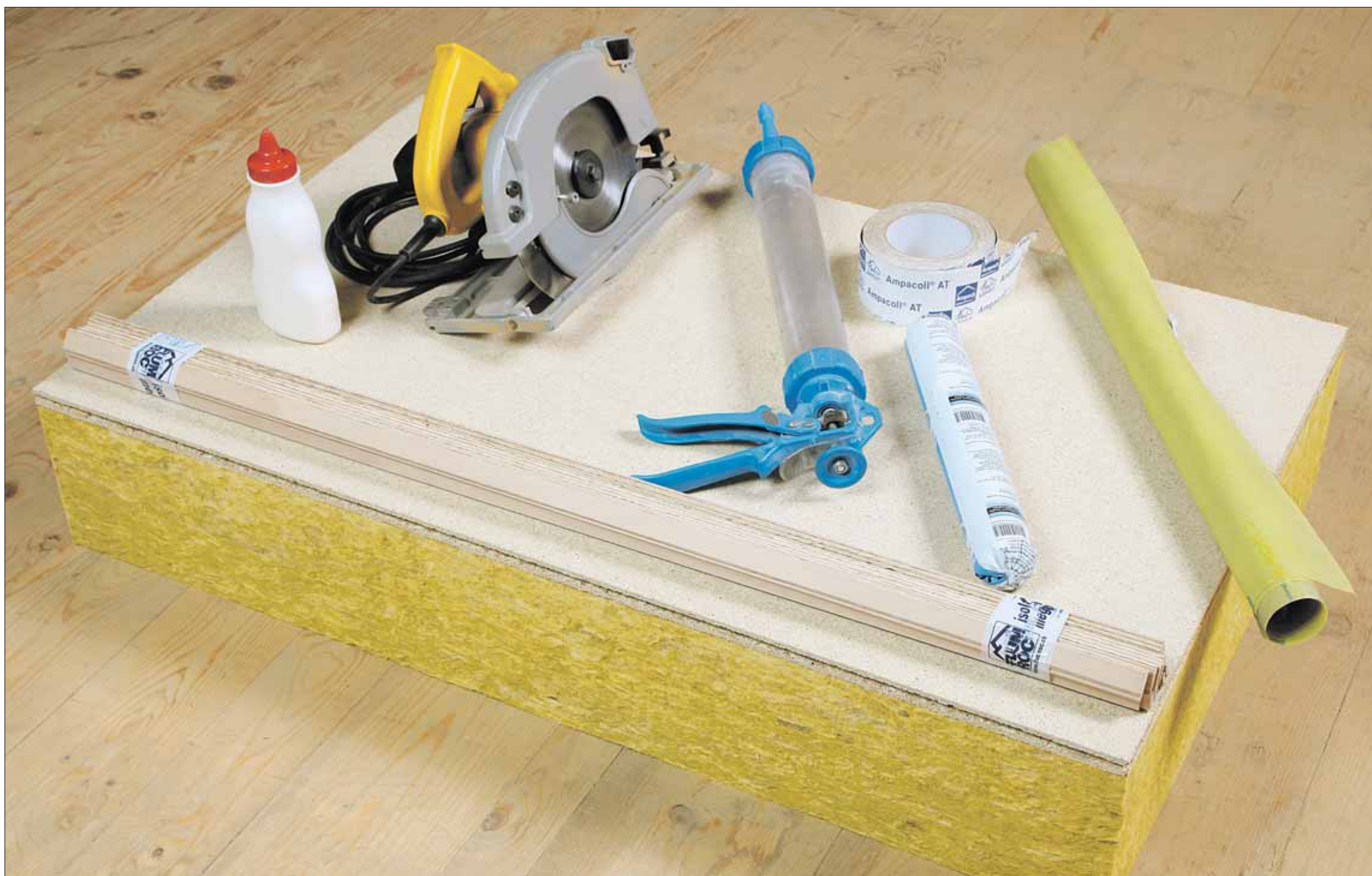
Isoler le sol des combles n'est pas sorcier avec la pose de plaques d'isolation pratiques. Avec un peu d'adresse, vous pourrez à la rigueur effectuer vous-même les travaux. A cet effet, voici les outils de travail requis: colle à froid pour le bois résistante à l'eau, scie circulaire, silicone, ruban adhésif approprié, couche d'étanchéité à l'air, languettes en bois dur. (Photos: Flumroc AG)
