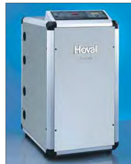
Une pompe à chaleur, comme ici la Hoval Thermalia, convertit en chaleur de chauffage l'énergie captée par la sonde géothermique. A cet effet, pour une puissance calorifique de 5,4 kW par exemple, elle ne requiert que 1,2 kW de courant. Et elle permet d'obtenir des températures de préchauffage de 50°C, voire de 65°C.
