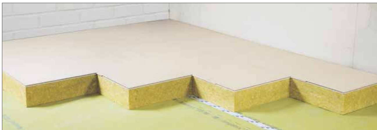
Les plaques d'isolation devraient avoir une épaisseur d'au moins 14 à 20 cm, afin que la chaleur ne s'échappe pas de la maison vers le haut en hiver et que la canicule ne se propage pas vers le bas en été.
