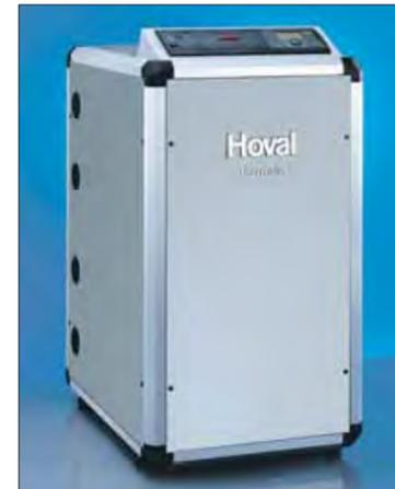
**Una pompa di calore come la Hoval Thermalia trasforma in calore per il riscaldamento l'energia ottenuta con la sonda geotermica. Per una potenza termica di 5,4 kW ha ad esempio bisogno di soli 1,2 kW di corrente e consente però di raggiungere temperature di mandata di 50°C o addirittura di 65°C.** Foto: Hoval Herzog AG
