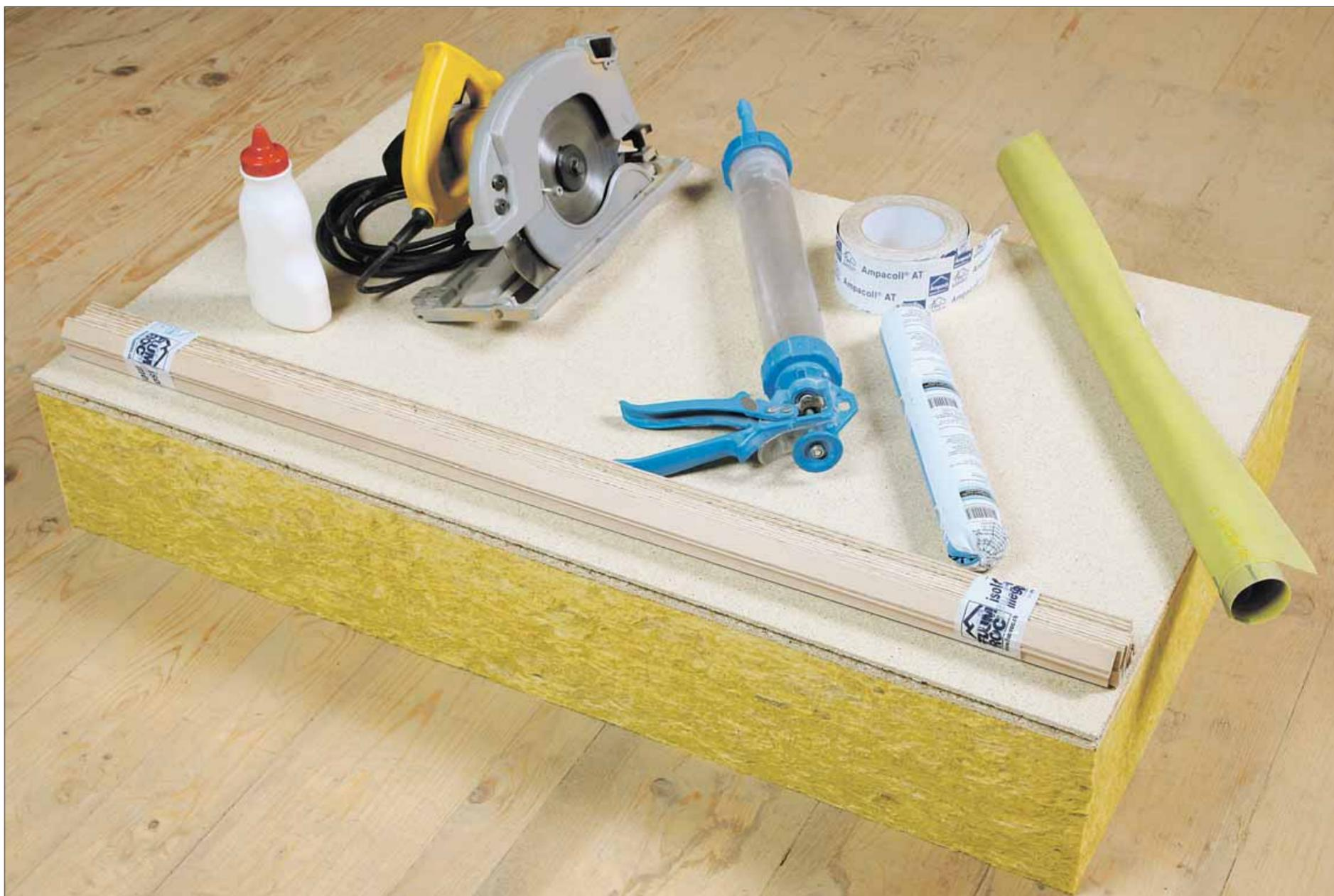
Se per coibentare il pavimento della soffitta impiegherete un pannello isolante calpestabile, la posa in opera non è nulla di trascendentale. Se avete un po' di manualità, potrete persino eseguire i lavori da soli. Per farlo, vi occorrono i seguenti utensili: colla a freddo impermeabile per legno, sega circolare, silicone, nastro adesivo adatto, strato ermetico all'aria e linguette di legno duro. (Foto: Flumroc AG)
