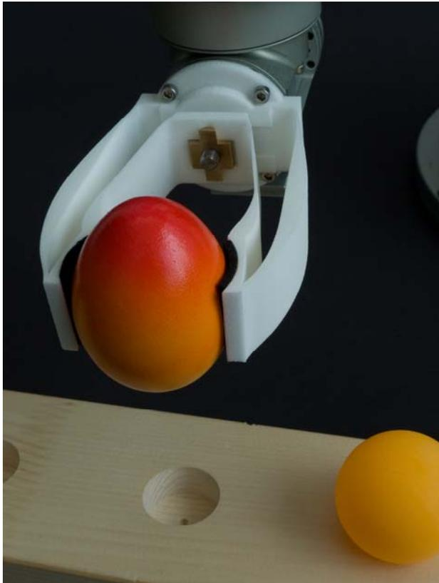
Les systèmes de matériaux intelligents adaptatifs permettent de produire des outils peu coûteux. La pince de préhension de ce bras de robot est fabriquée d'une seule pièce.
