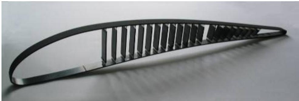
Les systèmes compliants permettent de construire une structure portante d'une aile composée d'une seule pièce.
