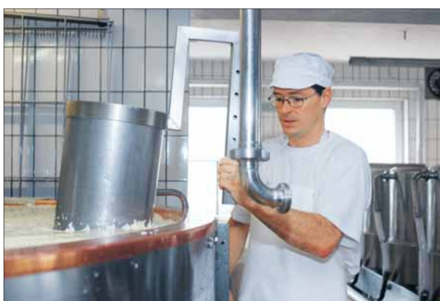
10h00: la masse se sépare à raison de 10% de grains de fromage et de 90% de petit-lait. A ce moment, la corbeille de filtrage mise au point par Josef Gut entre en scène.
