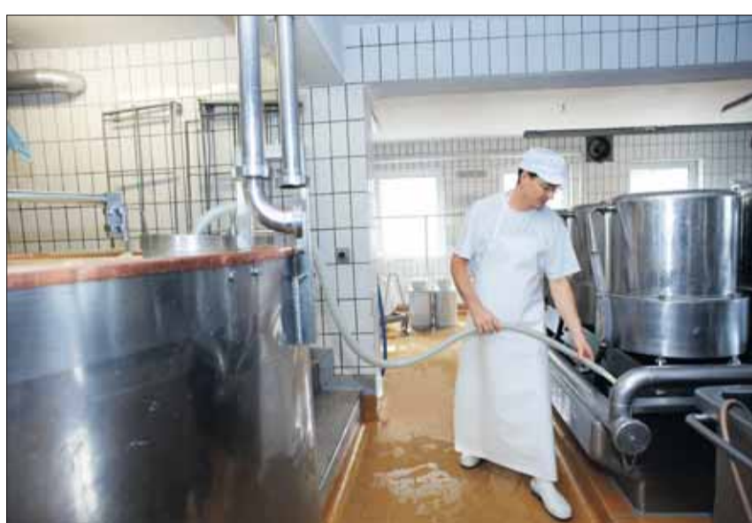
Durant le réchauffage à 55° C, il lui est possible, grâce à cette invention, d'aspirer environ 25% du petit-lait et d'économiser ainsi beaucoup d'énergie.
