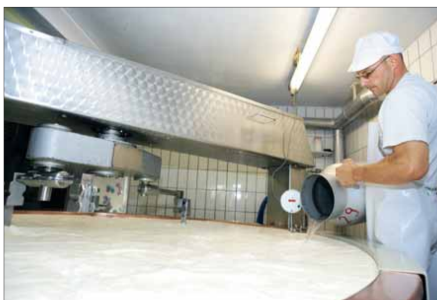
09h00: une fois la chaudière remplie, on ajoute la présure puis le lait est chauffé à 32° C.
