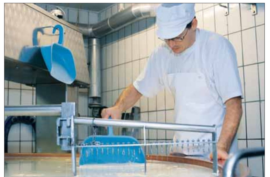
09.35 Uhr: Josef Gut beginnt mit dem Vorkäsen. Er beobachtet die Konsistenz sorgfältig und setzt im richtigen Moment die Harfe in Gang, welche die Masse zerschneidet.
