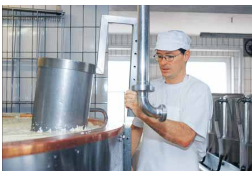
10.00 Uhr: Die Masse trennt sich in 10 Prozent Käsekörner und 90 Prozent Schotte (Molke) auf. Jetzt setzt Josef Gut den selbst entwickelten Filterkorb ein.
