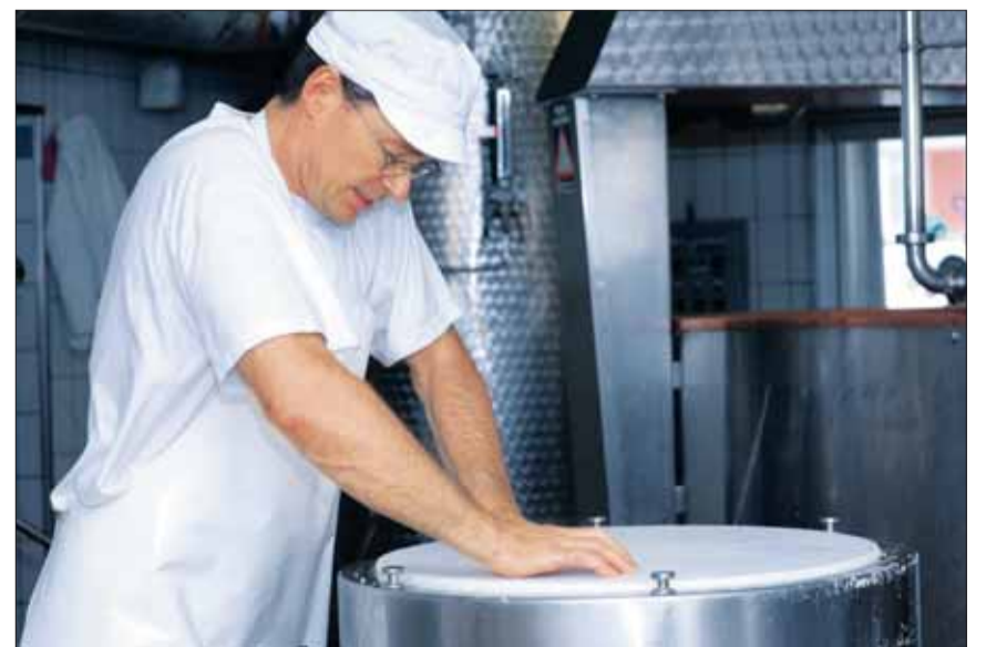
...und bis zum nächsten Morgen maschinell mit einem Druck von 1100 Kilogramm zusammengepresst.
