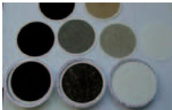
Figur 1: Filter nach Beprobung einer handbeschiedten Holzheizung. (HSLU)
