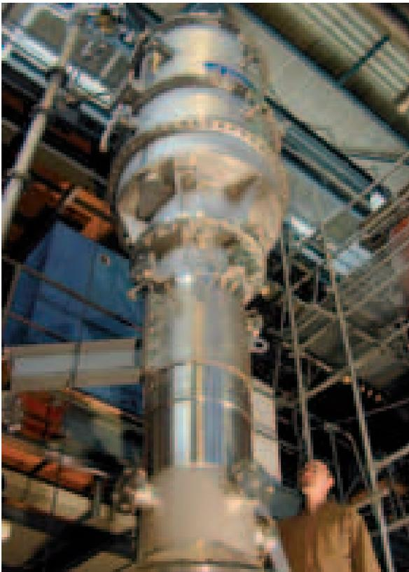
Figur 3: Dampferzeuger-Modell, mit dem die Rückhaltung von radioaktiven Stoffen im Falle von schweren KKW-Unfällen untersucht wird. (Quelle: PSI)
