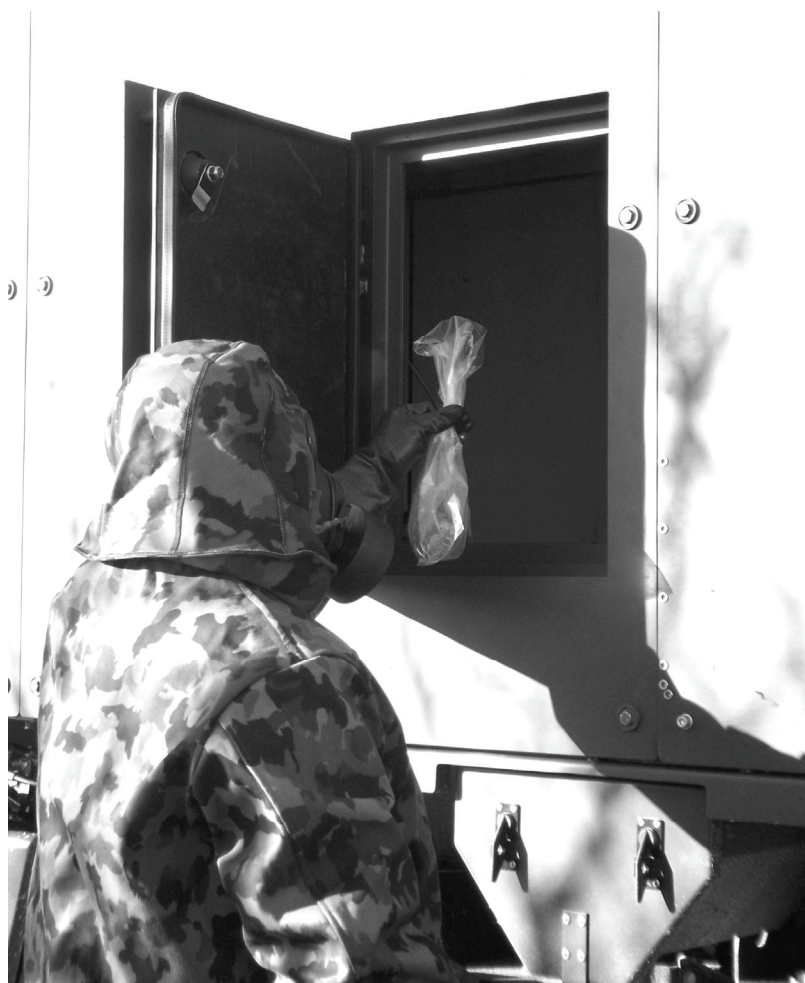
Sas pour la remise des échantillons
