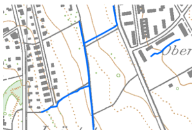
Offene Entwässerung bzw. Bachoffenlegung bei Siedlungserweiterung —
